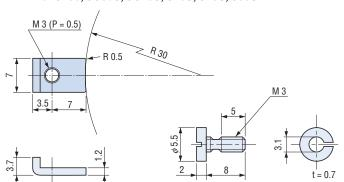
サーボマウント用取付爪は、ご要求に応じて支給が可能です。 The ratchet for servo mounting can be provided upon request.
