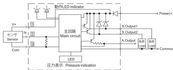
・ 電圧入力 NPN 出力 Voltage input NPN output
