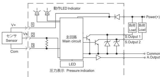
・ 電圧入力 PNP 出力 Voltage input PNP output
