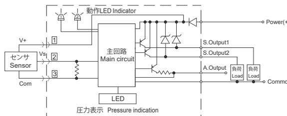
※ 2線式電流出力センサを使用する場合、(Com.) は N.C. とします。
