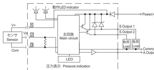
※ 2線式電流出力センサを使用する場合、(Com.) は N.C. とします。
