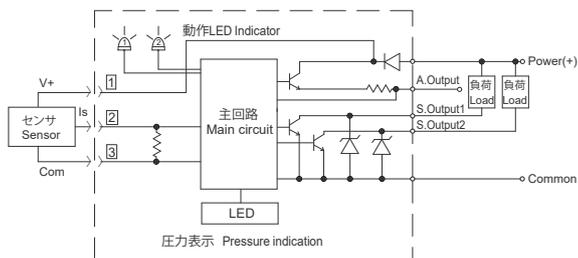
・ 電流入力 PNP 出力 Current input PNP output
