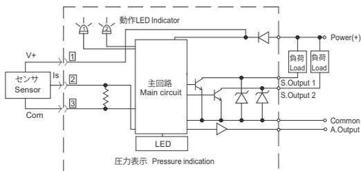
・ 電流入力 PNP 出力 Current input PNP output
