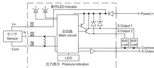
・ 電圧入力 NPN 出力 Voltage input NPN output
