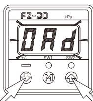
3桁LEDに“0Ad”が点滅しましたら、ボタンから外して下さい。ゼロ点調整処理が始まります。
